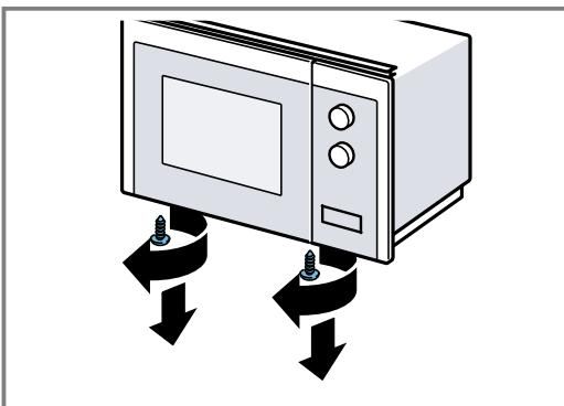
5. Rögzítse a mikrohullámú sütő alján a beépítő kereket a két külső csavarral.
