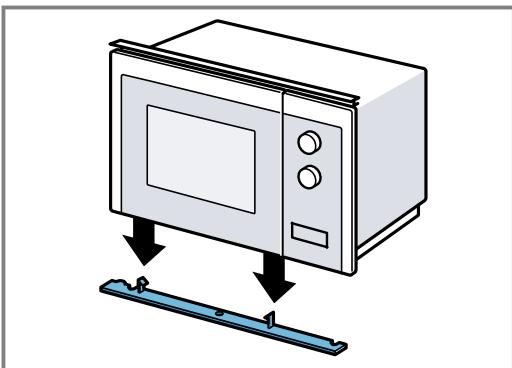
3. Зафиксируйте средний винт на основании микроволновой печи.
