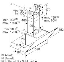
(3) Luftaustritt - Schlitze bei Abluft nach unten montieren Maße in mm
